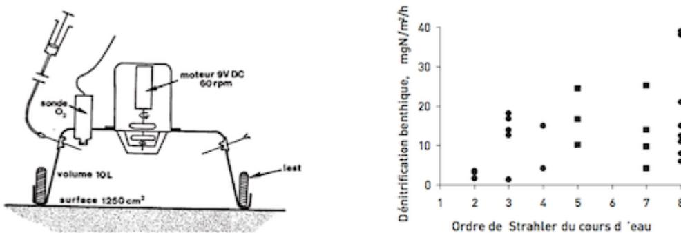
Figure 20 : a. Cloches benthique permettant la mesure des flux de dénitrification benthique.
