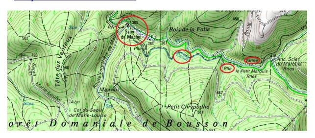
un canal assis sur une courbe de niveau a permis d'obtenir une chute de 40 mètres
