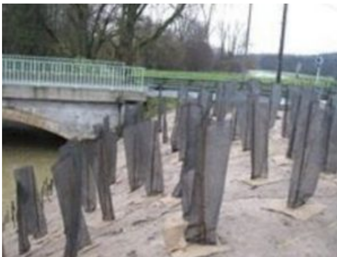
Après quelques années au soleil, ces manchons de protection des plants se désagrègent en petites particules qui rejoindront le cours d'eau.
